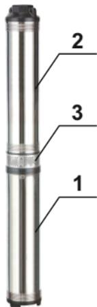
Насос состоит из **электродвигателя -1** и **насосного узла - 2**, расположенных в корпусе из нержавеющей стали. Двигатель насоса однофазный, герметичный с короткозамкнутым ротором на подшипниках качения и встроенным конденсатором.
